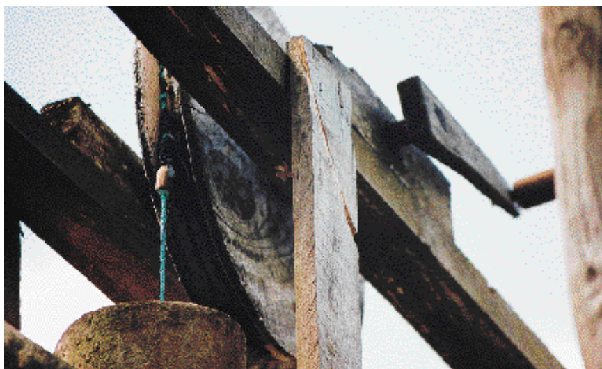
El movimiento mecánico de esta polea, en la parte superior de la bomba e inferior del pozo, generará la energía para elevar el agua.
