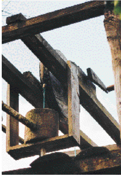
La pita con nudo o con intercepciones de madera (empaques) cada 50 cm es la que genera, con el movimiento circular, que se forme la columna de agua.
