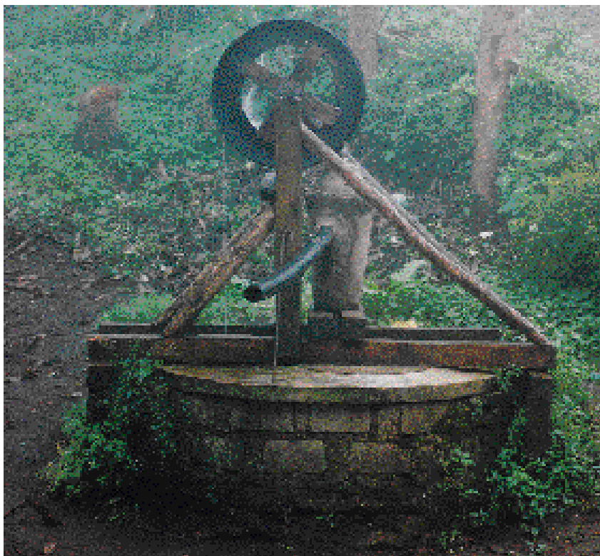
La bomba de lazo en una técnica que permite elevar columnas de agua haciendo uso de recursos de la región y al menor costo.
