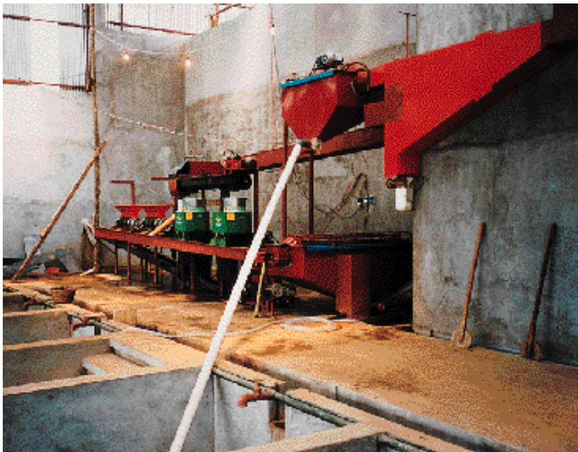
Para economizar agua, tanto la clasificación del café cosechado (en canal sifón) como el despulpado, se deben hacer en seco como se aprecia en la fotografía.
