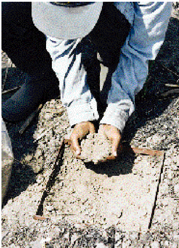
Para la toma de muestras de suelo se usa el marco y cilindro de hierro.
